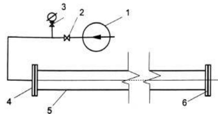
Рис. 15. Схема гидравлического испытания трубопровода из полипропиленовых труб.
