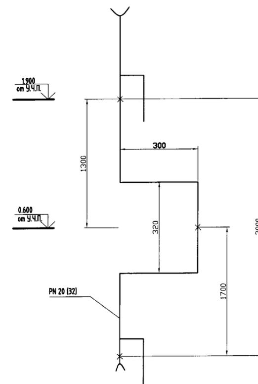
**ПРИМЕРЫ ПРИМЕНЕНИЯ ТРУБЫ STABI PP-RCT (ТРУБЫ PN 20, АРМИРОВАННЫЕ AL)**
