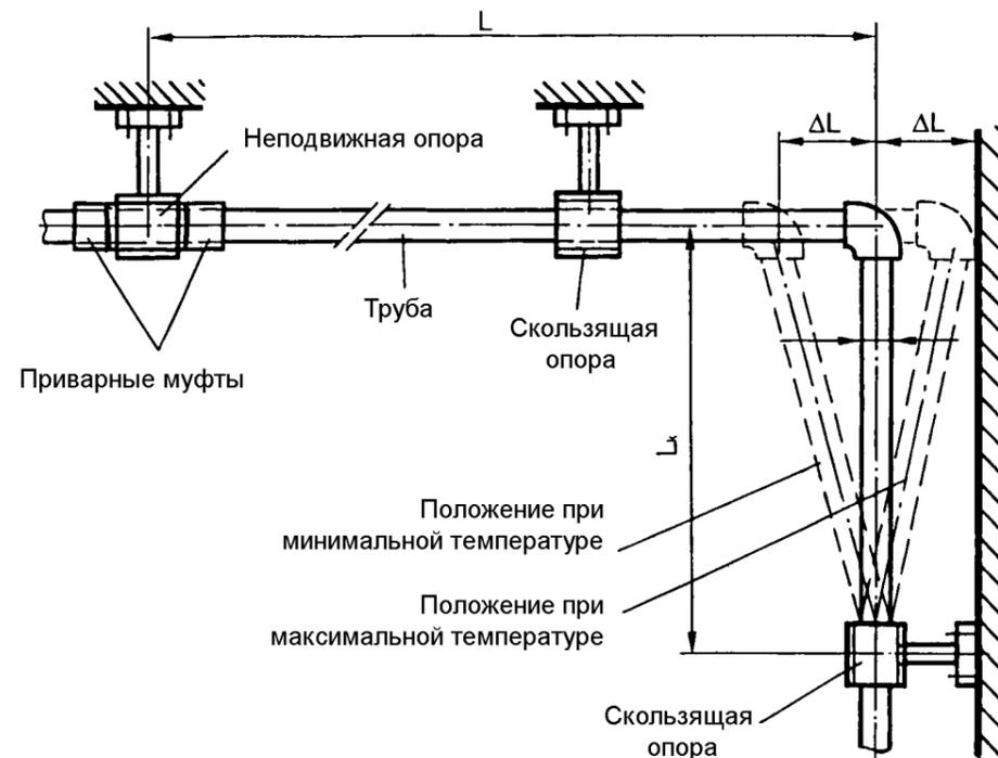
Рис. 8. Г-образный компенсирующий элемент трубопровода.
