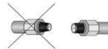
Перед началом раструбной сварки убедитесь, что трубы и детали не имеют повреждений и загрязнений. Поврежденные детали следует отбраковать, а загрязненные – очистить и обезжирить.
