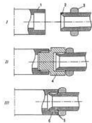
Рис. 12. Последовательность процесса контактной сварки труб в раструб.
