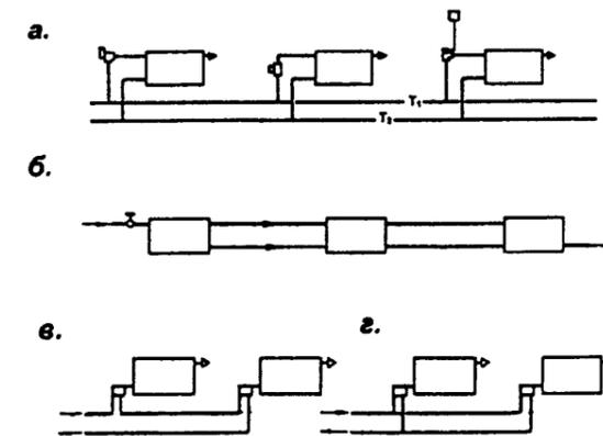
4) Схемы разностороннего присоединения труб к радиаторам при движении теплоносителя сверху вниз:
