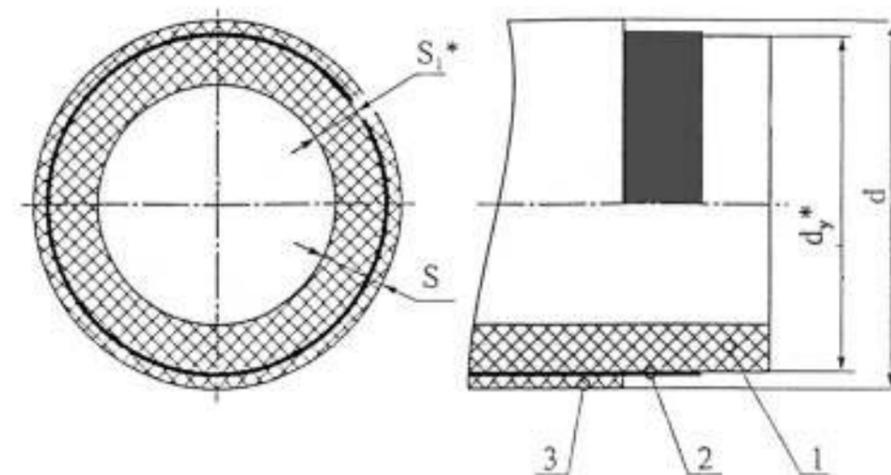
**Рис. 1. Схема армированной трубы**
