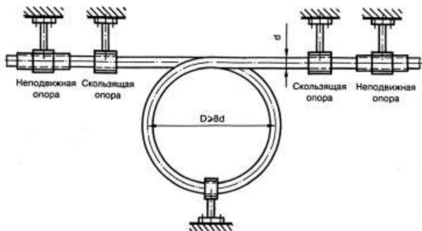
Рис. 10. Петлеобразный компенсатор.
