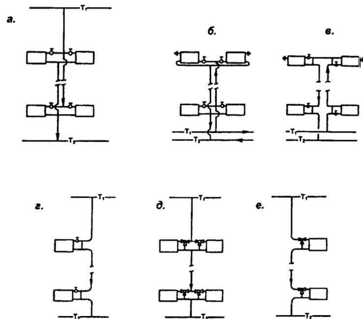
3) Схемы горизонтальных систем водяного отопления:
