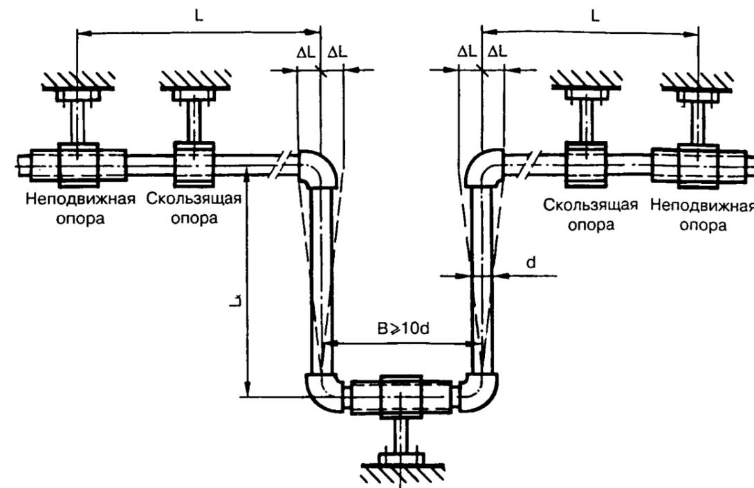
Рис. 9. П-образный компенсатор.
